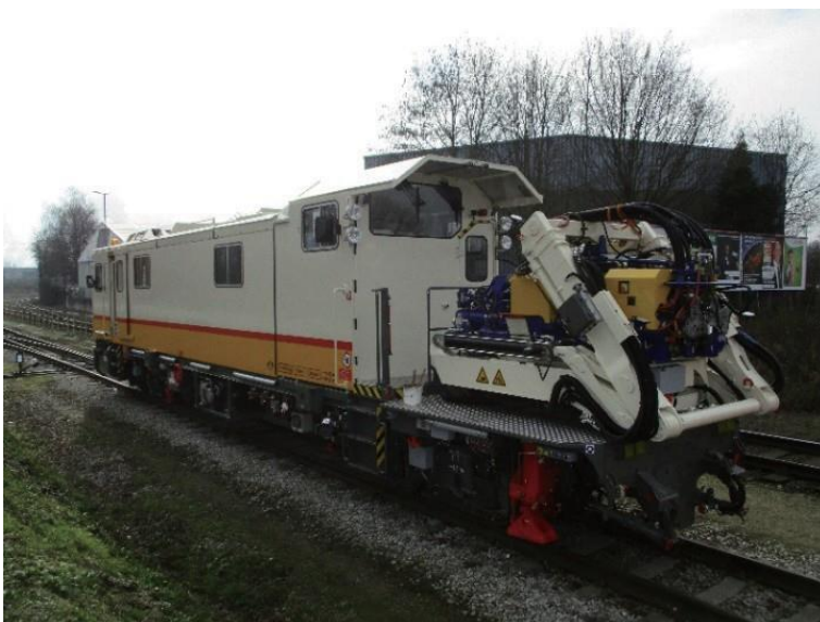
プラッサー社／オーストリア フラッシュバットレール溶接車
