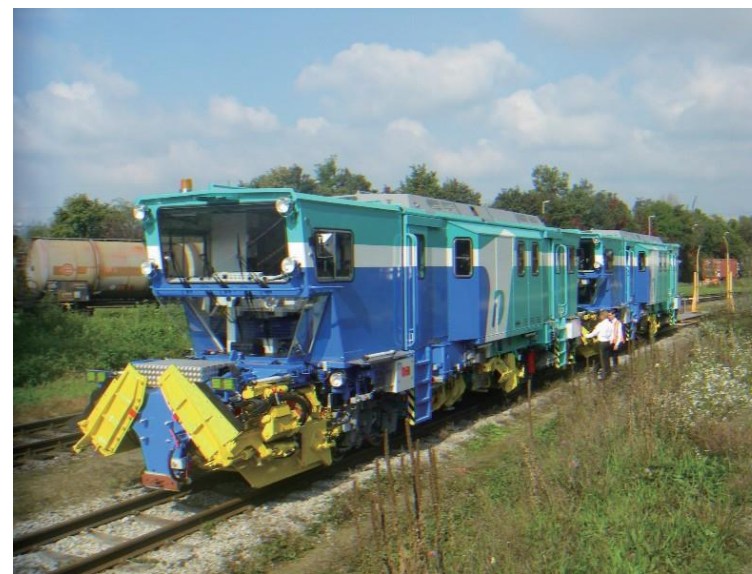
プラッサー社／オーストリア バラストレギュレーター（BR）
