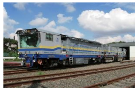
スペノ社製 レール削正車
